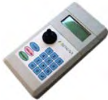
Abb. 5: Handgerät zum photometrischen Auslesen von Senova Minisäulen
